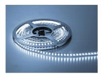
Extrem heller, flexibler LED-Streifen 120 W/5m (24 W/m), 120 SuperBright-LEDs/m, 12 mm breit, 5 m lang (auf Rolle abgepackt), dimmbar, alle 5 cm trennbar, selbstklebend. Gleichbleibende Helligkeit über die Gesamtlänge von 5 m (kein Helligkeitsverlust)
