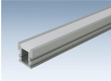
Begehbares Aluminiumprofil für Bodenmontage, mit Diffusor, mit Endkappen. Geeignet für LED-Streifen bis 11 mm Breite. Einsetzbar im trockenen Innenbereich. Belastbar bis 10 kN
