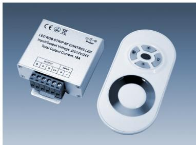
Controller für RGB-LED-Streifen oder -Leuchten, mit Fernbedienung. Funktionen: Stufenlose Farbauswahl, Dimmen, vorprogrammierte Farbwechsel, Ein-/Ausschalten. Für Verbraucher bis max. 144 W (24 V). Bis zu 10 Controller lassen sich mit einer einzelnen Fernbedienung synchron steuern
