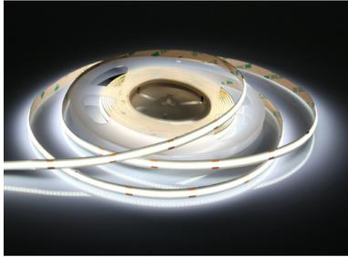
Flexibler LED-Streifen bestückt mit durchgehenden COB-LEDs (384 chips/m), wodurch ein gleichmäßiges Lichtband ohne sichtbare LED-Punkte entsteht (pixelfrei / dot-free), Abstrahlwinkel 180°, Farbwiedergabe CRI > 90, selbstklebend, 8 mm breit, dimmbar, 5 m lang, alle 41,5 mm trennbar. Gleichbleibende Helligkeit über die Gesamtlänge von 5 m (kein Helligkeitsverlust)
