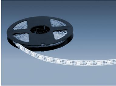
Flexibler LED-Streifen, bestückt mit einzeln ansteuerbaren RGB-LEDs, max. 18 W/m, 60 LEDs/m, 10 mm breit, 5 m lang (auf Rolle abgepackt), dimmbar, nach jeder einzelnen LED trennbar, selbstklebend. Ansteuerbar mittels Controllern mit vorprogrammierten Effekten (z.B. LED-Lauflicht), oder mit völlig frei programmierbaren Controllern für beliebige Effekte. Stromversorgung mittels Transformator 5 V DC
