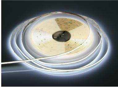
Flexibler COB-LED-Streifen (480 chips/m), 20 m-Rolle, praktisch ohne Helligkeitsabfall auf der gesamten Länge, pixelfrei / dot-free, Abstrahlwinkel 180°, Farbwiedergabe CRI > 90, selbstklebend, 8 mm breit, dimmbar, alle 50 mm trennbar. Die gesamten 20 m können mit einem einzigen Transformator in voller Länge betrieben werden, ohne sichtbaren Helligkeitsverlust am Ende des Streifens
