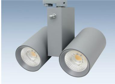
High-Power-LED-COB-Schienenstrahler 90 W (2 x 45 W) mit einstellbarer Lichtfarbe (3000 K, 4000 K, 5700 K), mit Adapter für 3-Phasen-Euro-Schienensystem. Hochwertiges Aluminiumgehäuse, 360° dreh-/schwenkbar. Mit Öse zur Befestigung eines Sicherungsseils (Safety). Abstrahlwinkel durch Tausch der Streulinse anpassbar (optional, Fluter 60° / Spot 30°). Flickerfreie LED. 7600 bis 9000 lm (je nach Lichtfarbe). CRI > 90
